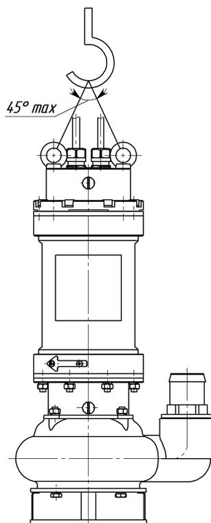
Рисунок 10 – Схема строповки
