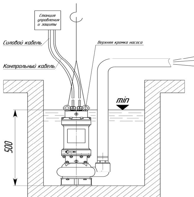
Рисунок 7 – Схема установки
