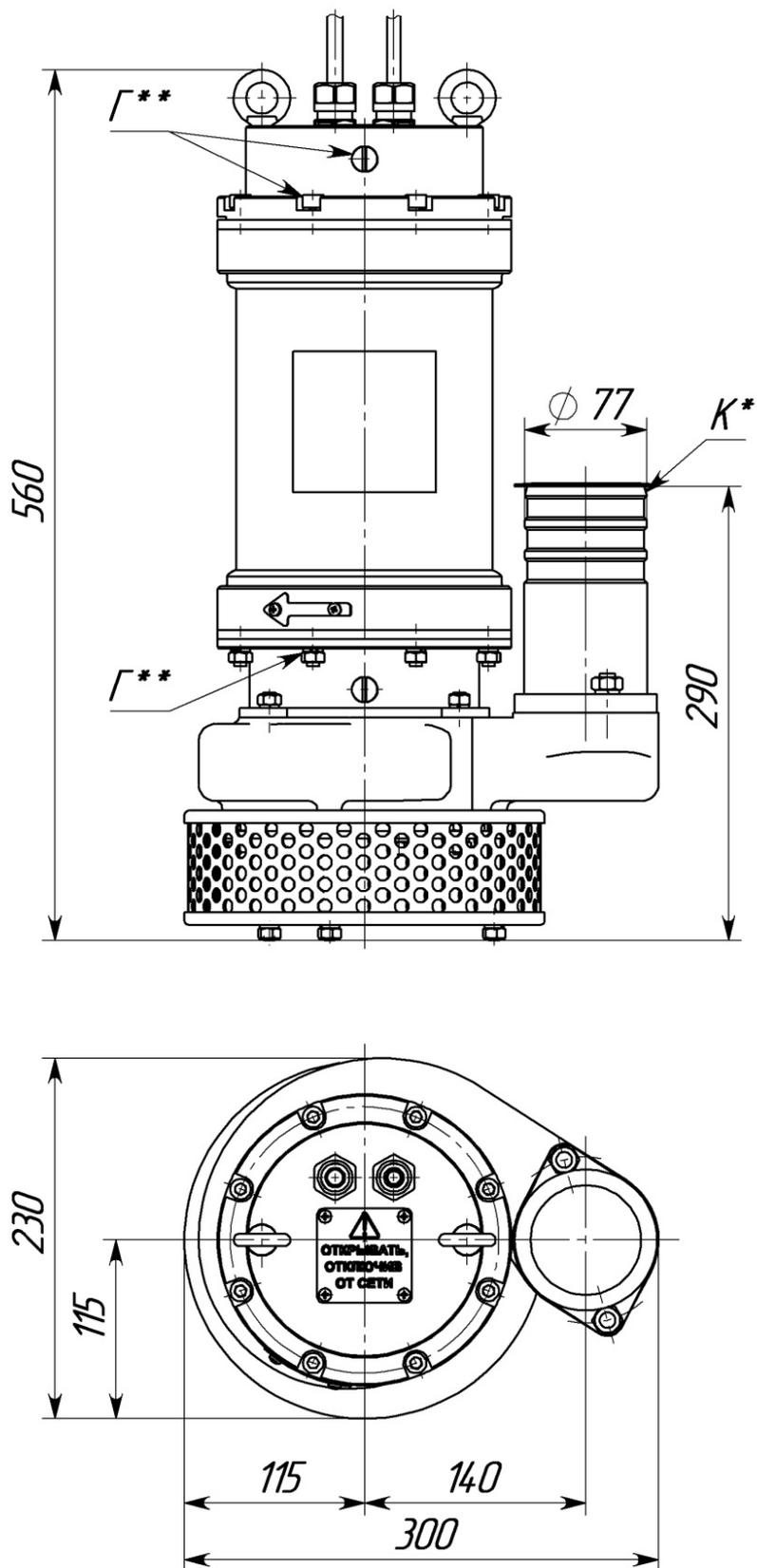
Рисунок 2 – Габаритные размеры электронасоса Гном 25-20Ех
