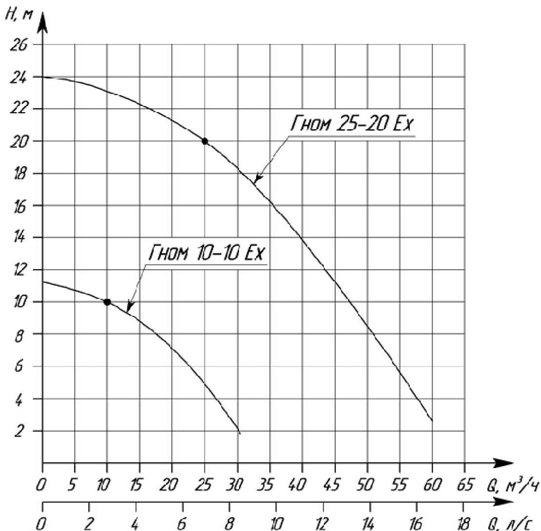
Рисунок 3 - Характеристика электронасосов
