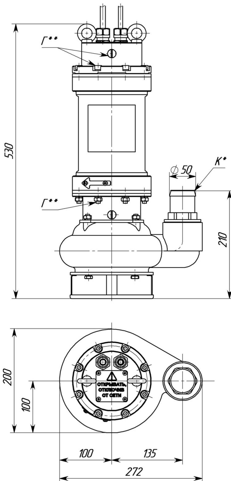
Рисунок 1 – Габаритные размеры электронасоса Гном 10-10Ex
