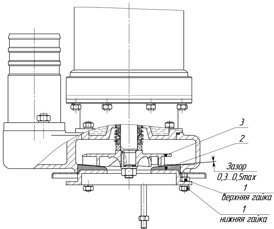
Рисунок 9 – Регулировка зазора электронасоса Гном 25-20 Ех
